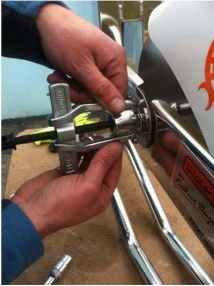
4) Démontez la manivelle avec un arrache moyeu
