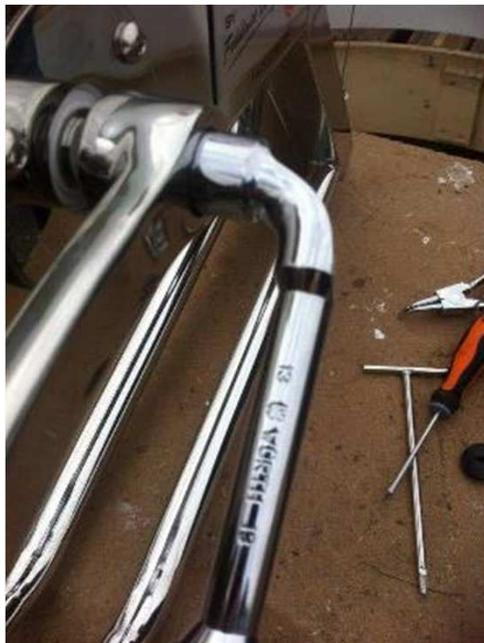
3) Démonter la vis de manivelle avec une clé à pipe de 13mm
